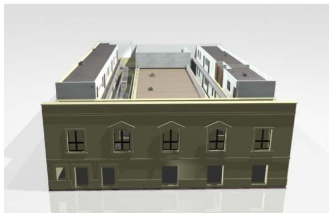
Fig. 2. Proyecto de rehabilitación (viviendas nuevas en el último nivel en los cuerpos laterales). Rehabilitation project (new houses in the last level in the lateral bodies)
