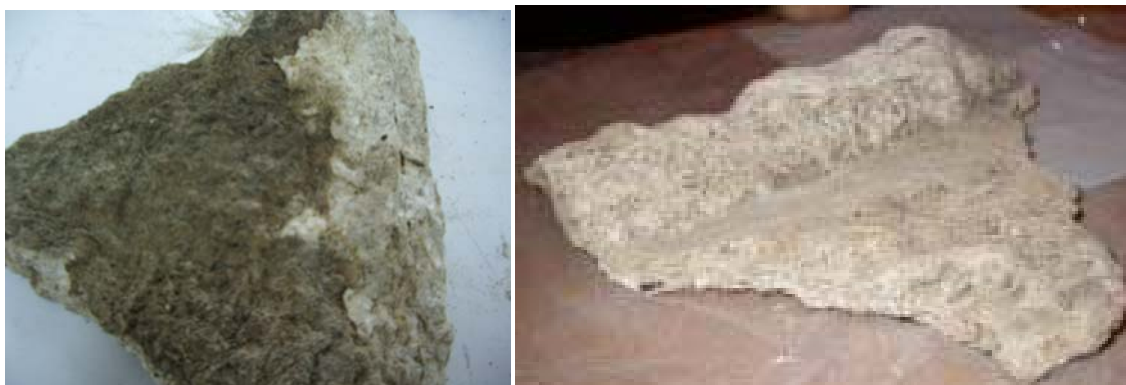
Fig. 3: a) Cara posterior de la muestra, presencia de la capa terrosa en contacto con la fábrica de ladrillo. b) Cara vista de la muestra 3 A con media caña decorada a la izquierda de la muestra.
