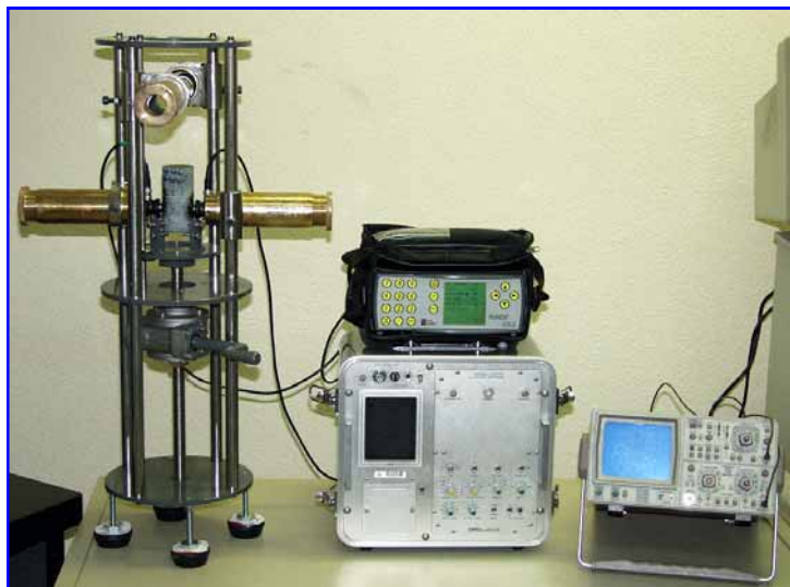
Figura 2. Equipo utilizado para la determinación de las variaciones de velocidad (ondas P) entre las probetas tratadas y sin tratar. En la imagen se pueden distinguir el equipo ultrasónico, un osciloscopio (derecha) y un estativo (izquierda), este último a fin de garantizar un contacto firme de los transductores con la superficie de la roca.
