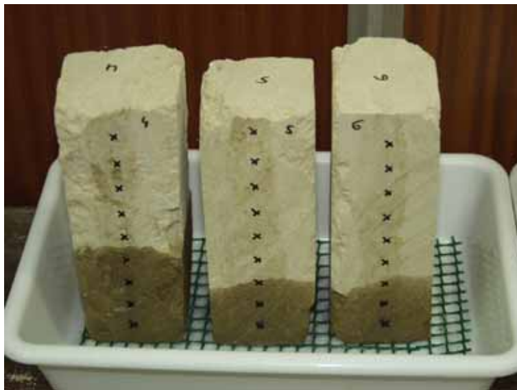
Figura 1. Prueba de consolidación en el laboratorio mediante ascensión capilar. Se puede observar la altura alcanzada por el consolidante sobre las probetas de roca (caliza margosa) (altura capilar de los productos) a las 2,5 horas de su aplicación.
