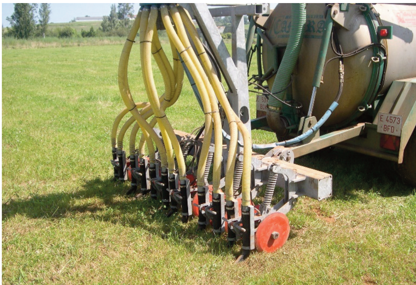
FOTO 1. Equipo de inyección de purín utilizado.
