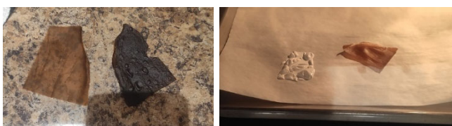
Fig. 3. Muestras ensayadas para evaluar la resistencia a la combustión
