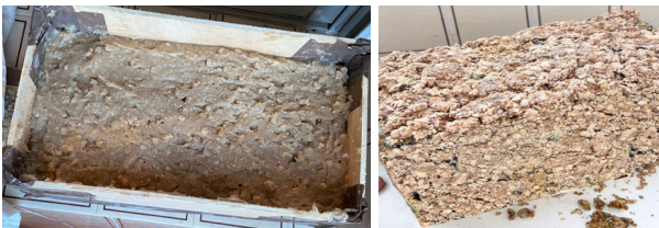
Fig. 5. Molde con la mezcla y probeta tras ser desmoldada
