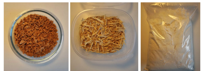
Fig. 1. Izquierda a derecha: corcho, paja y celulosa usadas para la fabricación de las probetas
