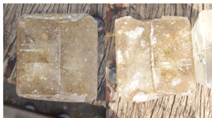
Fig. 3. Probeta fabricada con arena, antes y después del ensayo de impacto
