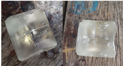
Fig. 2. Probeta fabricada con fibra de vidrio, antes y después del ensayo de impacto
