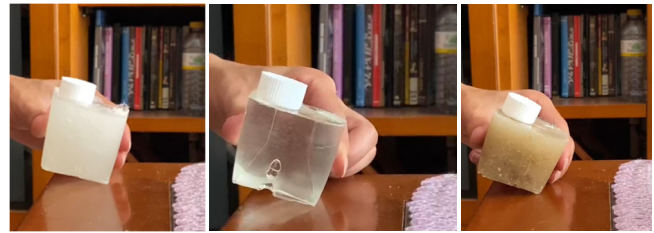
Fig. 4. Resultado de los ensayos de deslizamiento en las tres probetas estudiadas
