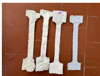
Fig. 1. Probetas utilizadas, para el ensayo de tracción y flexión
