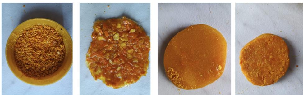
Fig. 1. Izquierda a derecha: Polvo de mandarina, Primera probeta con trozos de mandarina, Probeta con un 50 % de piel de mandarina y 50 % de pegamento y Probeta con un 75 % de silicona y 25 % de piel de mandarina
