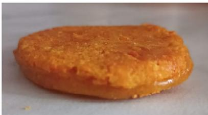
Fig. 2. Prototipo de suela fabricado combinando las probetas 2 y 3
