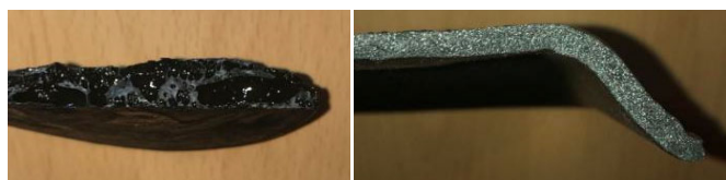
Fig. 4. Estructura interna del posavasos y de la bandeja de poliestireno expandido
