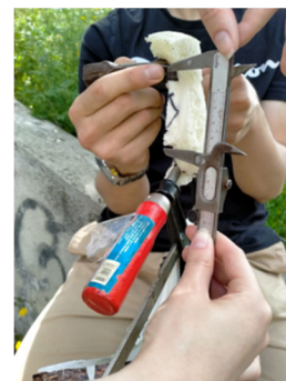
Fig. 3. Dispositivo empleado en el ensayo de tracción
