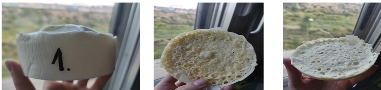
Fig. 1. (Izquierda a derecha) Muestra fabricada con poliuretano, con poliuretano y aceite y con poliuretano, aceite y maicena
