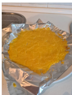
Fig. 3. Bioplástico tras la exposición a alta temperatura
