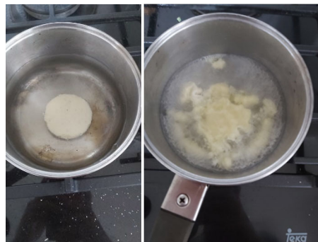
Fig. 6. Ensayo resistencia al agua de pastilla en agua a temperatura ambiente (izquierda) y Ensayo resistencia al agua de pastilla en agua a alta temperatura (derecha)
