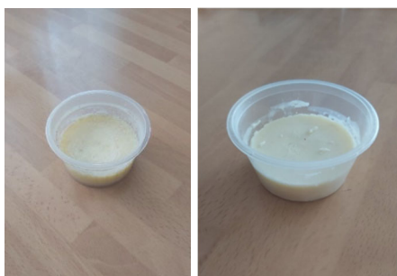
Fig. 5. Ensayo de capacidad de solidificación de la pastilla sin maicena (izquierda) y con maicena (derecha).
