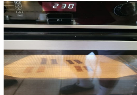
Fig. 2. Tratamiento térmico de las muestras
