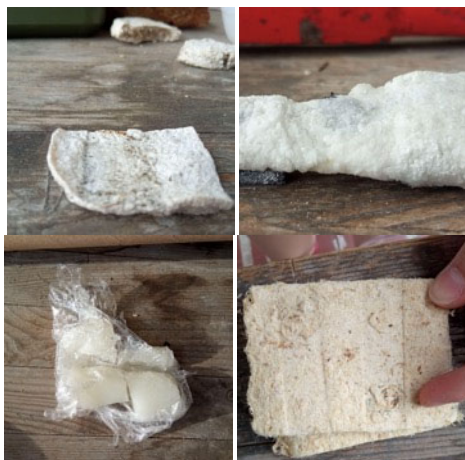
Fig. 21. Probetas tras el ensayo de compresión
