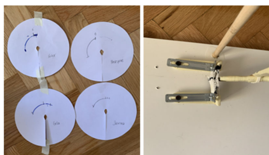
Fig. 24. Resultados del ensayo de resistencia a impacto (izquierda) y probeta del material Ketex que no ha roto (derecha)
