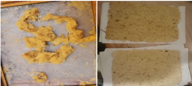
Fig. 7. Masa de celulosa una vez blanqueada (izquierda) y láminas de celulosa (derecha)
