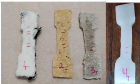
Fig.12. Probetas utilizadas para los ensayos de tracción, antes del ensayo
