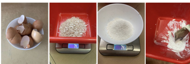
Fig. 2. Elementos utilizados para la fabricación de las muestras (de izquierda a derecha): cáscaras de huevo, cáscaras de huevo trituradas, harina de arroz, resina
