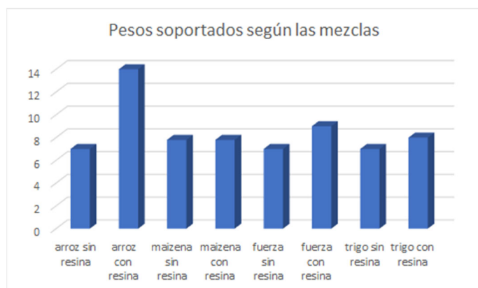
Fig. 6. Pesos soportados por cada una de las mezclas
