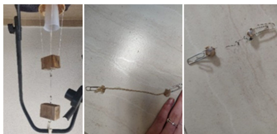
Fig. 7. Mecanismo de ensayo de tracción en fibras (izquierda) y fibra de cáñamo antes y después del ensayo (centro y derecha)
