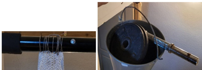
Fig. 3. Método de anclaje del sistema de tracción (izquierda) y sistema de carga empleada, cubo con distintas pesas (derecha)
