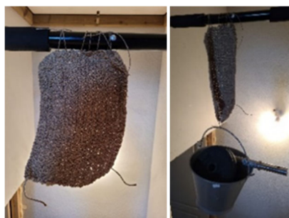
Fig. 4. Tejido de cáñamo sin peso aplicado (izquierda) y con aplicación de 20 kg de carga (derecha)
