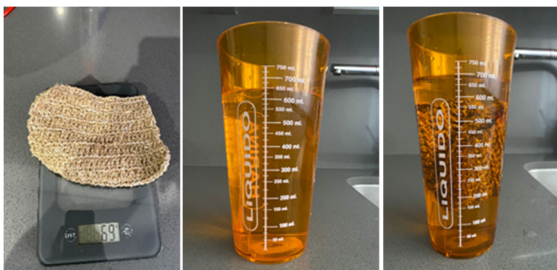
Fig. 9. Procedimiento de determinación de la densidad
