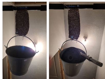
Fig. 6. Tejido mixto sin peso aplicado (izquierda) y con aplicación de 20 kg de carga (derecha)
