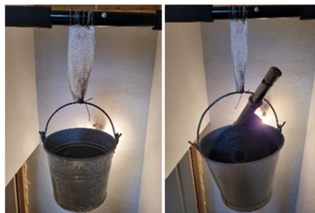
Fig. 5. Tejido de bambú sin peso aplicado (izquierda) y con aplicación de 20 kg de carga (derecha)
