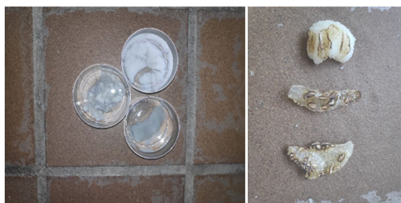
Fig. 2. Ensayo de permeabilidad (izquierda) y resistencia a la combustión (derecha)
