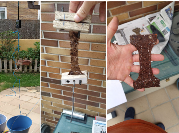
Fig 8. Secuencia del ensayo de tracción en las probetas fabricadas
