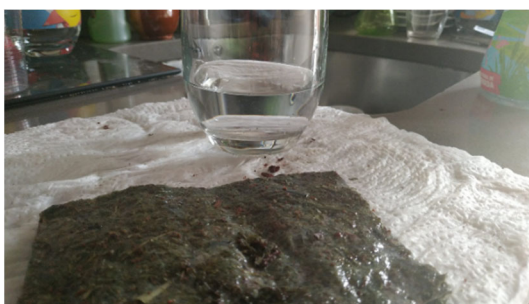
Fig. 3. Probeta de 80 % plátano y 20 % coco con 1L.
