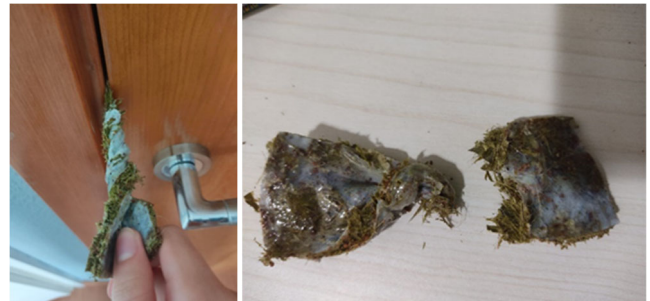
Fig 11. Probeta 80% de Plátano y 20% de coco, Durante el ensayo y tras el ensayo.
