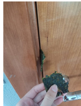
Fig 12. Probeta de 100% de Plátano tras finalizar el ensayo y no reisirir la tension tras una vuelta.
