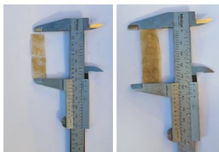
Figura 12. Elongación de la probeta por deformación plástica
