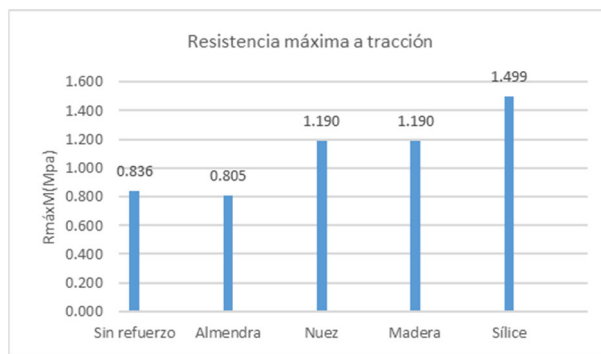
Figura 10. Comparación de la resistencia máxima a tracción, según el refuerzo
