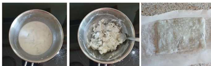
Fig. 1. Proceso de fabricación de las probetas: mezcla, calentamiento y secado de las muestras (izquierda a derecha)
