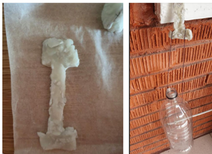
Fig. 2. Probeta utilizada para el ensayo de resistencia a tracción (izquierda) y procedimiento de ensayo (derecha)
