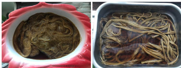
Fig. 1. Fibras de cáñamo durante baño alcalino, probeta 1 (izquierda) y probeta 2 (derecha)
