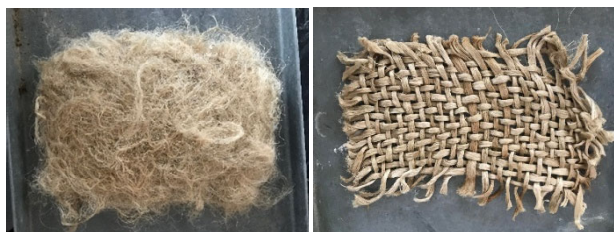
Fig. 2. Fibras de cáñamo tras baño alcalino, probeta 1 (izquierda) y probeta 2 (derecha)
