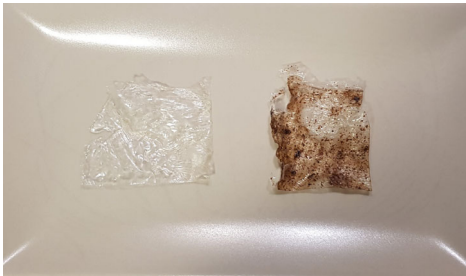
Fig. 5. Bioplásticos obtenidos sin cáscara de nuez (izquierda) y con cáscara de nuez (derecha)
