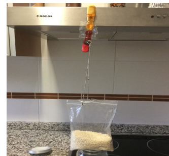
Fig. 4. Ensayo de tracción casero
