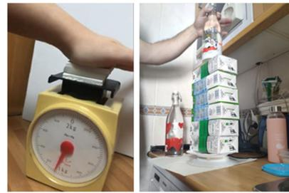
Fig. 4. Resistencia a compresión con: método 1 (izquierda) y método 2 (derecha)
