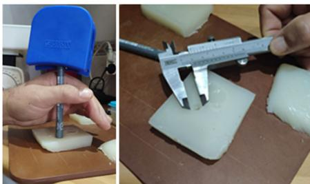
Fig. 3. Ensayo de dureza con bolígrafo (izquierda) y con canica (derecha)
