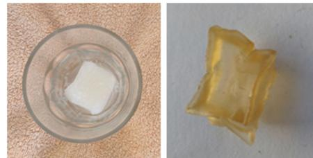
Fig. 6. Ensayo de solubilidad en agua fría (izquierda) y muestra del material tras estar expuesto al aire libre 5 días (derecha)
