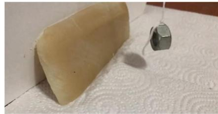
Fig. 5. Resistencia a impacto usando como indentador una tuerca
