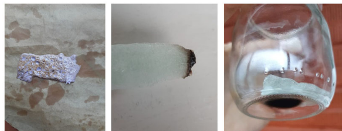
Fig. 5. Muestras tratadas a distintas temperaturas: entre 100 °C y 170 °C (izquierda), cuando comienza a fundirse (centro). La imagen derecha muestra el ensayo térmico indirecto realizado.
