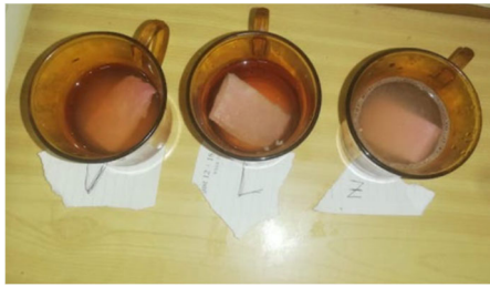
Fig. 7. Montaje del ensayo de degradación química
