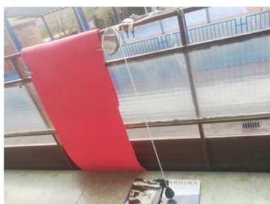
Fig. 4. Montaje del ensayo Izod
