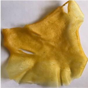
Fig. 3. Muestra fabricada con cáscara de naranja y un 100 % de glicerina (15 ml)
