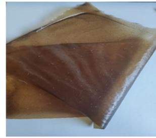
Fig. 6. Muestra fabricada con cáscara de plátano y un 100 % de glicerina (15 ml)
