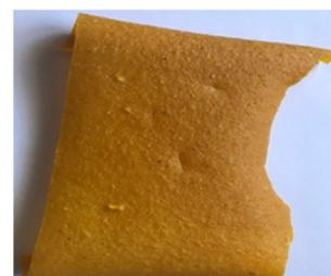
Fig. 2. Muestra fabricada con cáscara de naranja y un 50 % de glicerina (7,5 ml)
