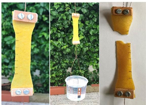
Fig. 9. Ensayos de tracción realizados en las probetas fabricadas con 15g de glicerina (100%) y cáscara de naranja. De izquierda a derecha: probeta de tracción utilizada, sistema de aplicación de carga y probeta tras el ensayo
