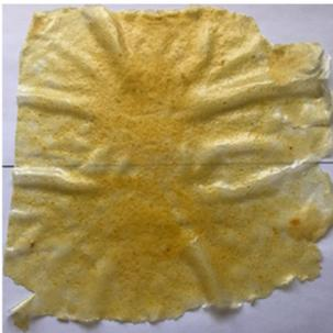
Fig. 4. Muestra fabricada con cáscara de naranja y un 200 % de glicerina (300 ml)
