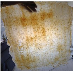
Fig. 5. Muestra fabricada con cáscara de mango y un 100 % de glicerina (15 ml)
