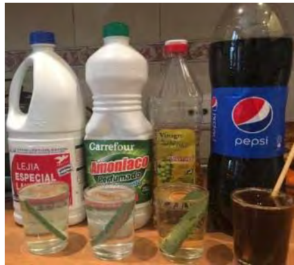
Fig. 4. Probetas sumergidas para los ensayos de elasticidad
