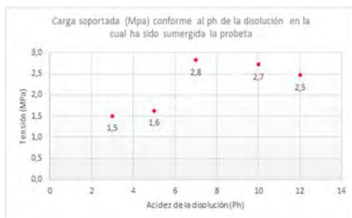
Fig. 5. Tensión frente a la acidez de la disolución
