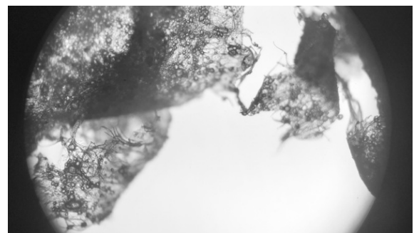
Fig.14. Esferas de colofonia sobre las fibras del papel.
