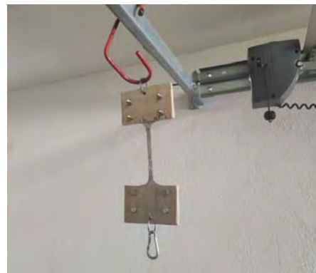
Fig.11. Inicio del ensayo a tracción.
