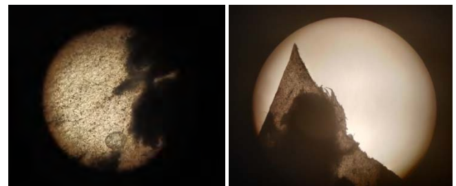
Fig.12.(izquierda) Estructura microscópica del material y Fig.13.(derecha) Estructura microscópica tras el ensayo a tracción.
