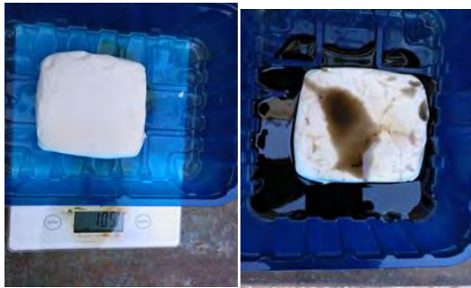
Fig. 8. Probeta antes y después del ensayo de corrosión
