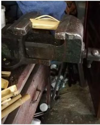
Fig. 5. Ensayo de compresión con tornillo de banco
