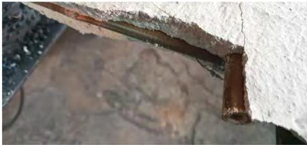
Fig. 15. Probeta tras el ensayo de flexión
