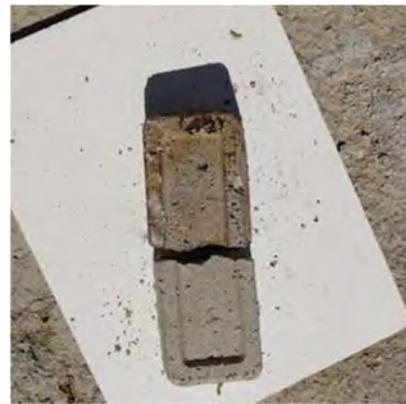
Fig. 17. Yeso antes y después de la aplicación de temperatura
