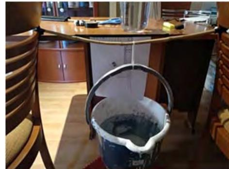
Fig. 4. Ensayo de flexión en tres puntos
