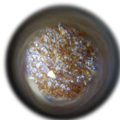
Fig. 10. Micrografía de la probeta 5 a 45 aumentos. Se aprecia la gran cantidad de partículas de serrín, el epoxi no se distingue debido a su transparencia
