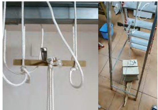
Fig. 6. A la izquierda detalle de una probeta de MDF en flexión y a la derecha vista general la probeta número 4 sosteniendo 27 kilos
