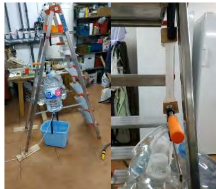
Fig. 5. A la izquierda vista general de la realización de los ensayos de tracción, dentro de la base de la escalera se observa el cubo de agua y 3 garrafas colgando de la probeta que a la derecha se ve, en detalle, colocada entre dos sargentas sosteniendo todo
