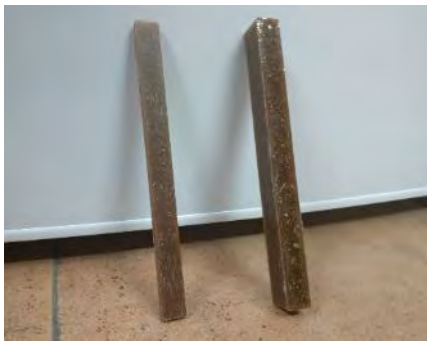
Fig. 3. Probetas para ensayos de flexión, compuestas de resina epoxi y serrín reciclado
