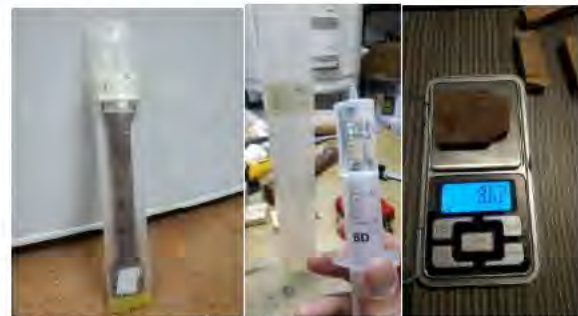
Fig. 1. Diversos instrumentos de medida, de izquierda a derecha: recipiente aforado, jeringuilla y báscula de precisión
