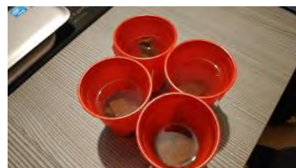
Fig. 7. Cada vaso contiene un fragmento de una probeta de MDF y otro de la probeta 4
