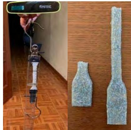
Fig. 6. Mecanismo utilizado para el ensayo de tracción (izquierda) y probeta traccionada (derecha)
