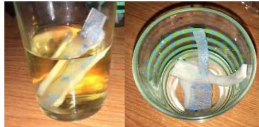
Fig. 5. Las probetas en un medio ácido (izquierda) y en un medio básico (derecha)
