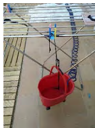
Fig. 4. Ensayo de flexión a tres puntos
