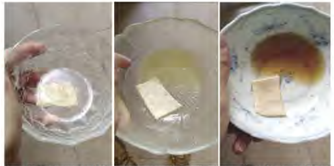
Fig. 7. Muestras pasadas 24 horas. En la izquierda pH neutro (etanol), en el centro pH básico (lejía) y en la derecha pH ácido (ácido acético).
