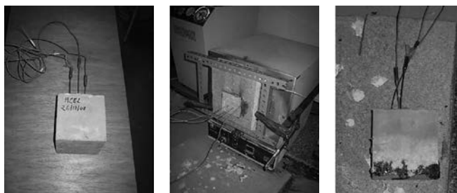
Probeta de hormigón con termopares.
