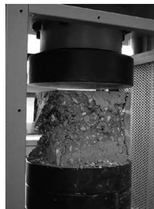
Fig. 4 Proceso de rotura de la probeta HCW F-4 en la máquina de compresión de hormigones. (Fuente: Elaboración propia).
