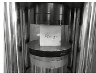
Rotura de probeta después de haber sido sometida a la acción térmica.
