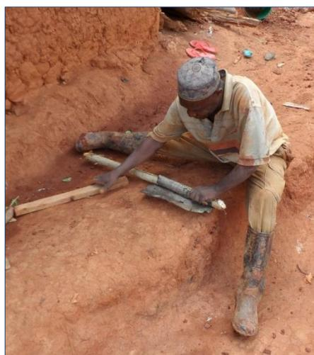
Figura 7. Detalle de la fabricación de la salida de la chimenea a partir de un sobrante de plancha de acero galvanizado corrugado, comúnmente utilizada para las cubiertas de los tejados en la zona del proyecto. Fuente: TFCG.
