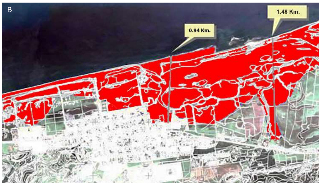
Figura 1. Carta de inundación modelada en la localidad de Arauco, región de Biobío, Chile. Se observa el rol de los humedales costeros y el cordón dunario como infraestructura de amortiguación de los efectos de inundación en el Tsunami del 27F. Arriba (A), Imagen satelital de la localidad de Arauco. Abajo (B), Plano con área de inundación del tsunami del 27F en la localidad de Arauco.
