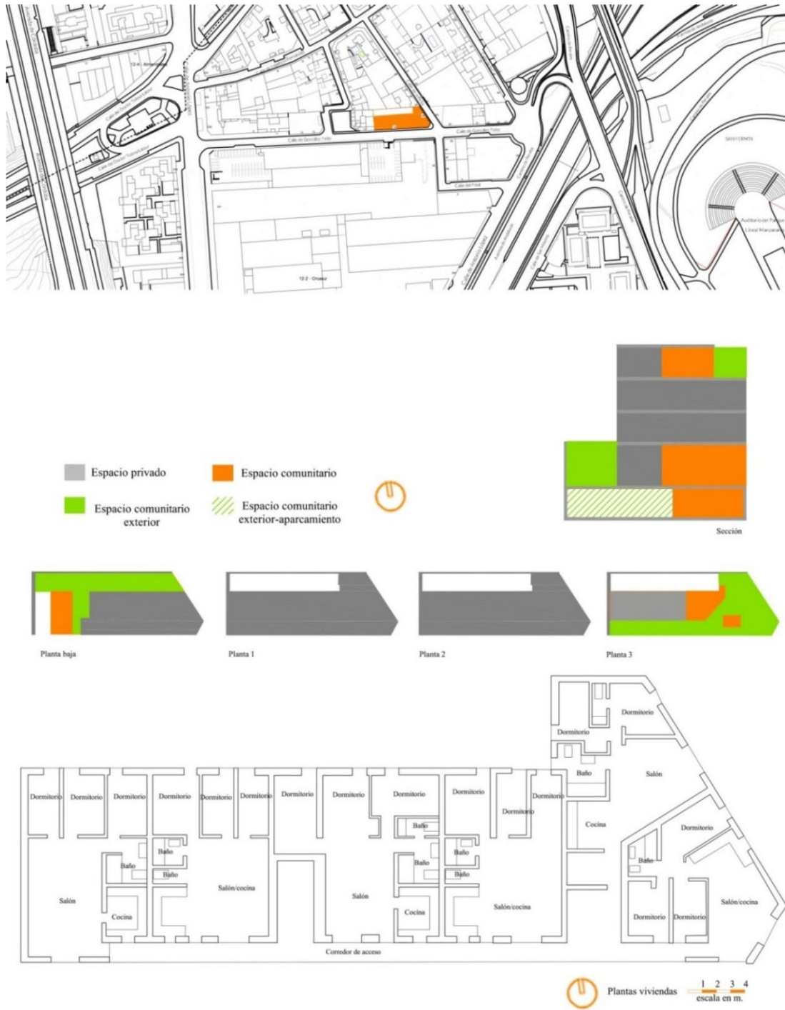
Figura 8. Plano de ubicación, esquemas en planta y sección de espacios privados, comunes, comunes exteriores y distribución de viviendas cohousing Las Carolinas. Fuente: entrepatrios.org y elaboración propia.
