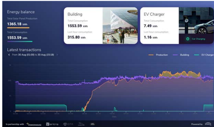
Imagen 18. Visualizador de producción y consumo energético, incluida la demanda de los coches eléctricos, del edificio Powerhouse Brattørkaia en Trondheim.
