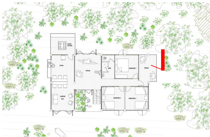
Fig. 10. Planta baja de vivienda de bambú Tomado de Vivienda vernácula de bambú [6]
