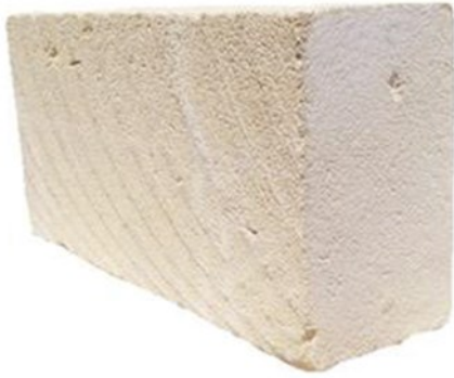
Fig. 11. Piedra empleada en la construcción, Tufo Calcareo.
