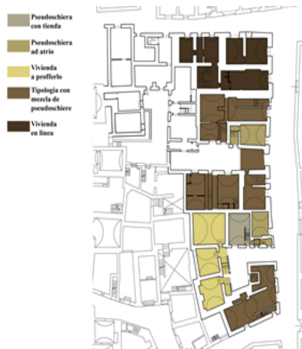
Fig. 14. Tipologías constructivas de la parcela elegida
