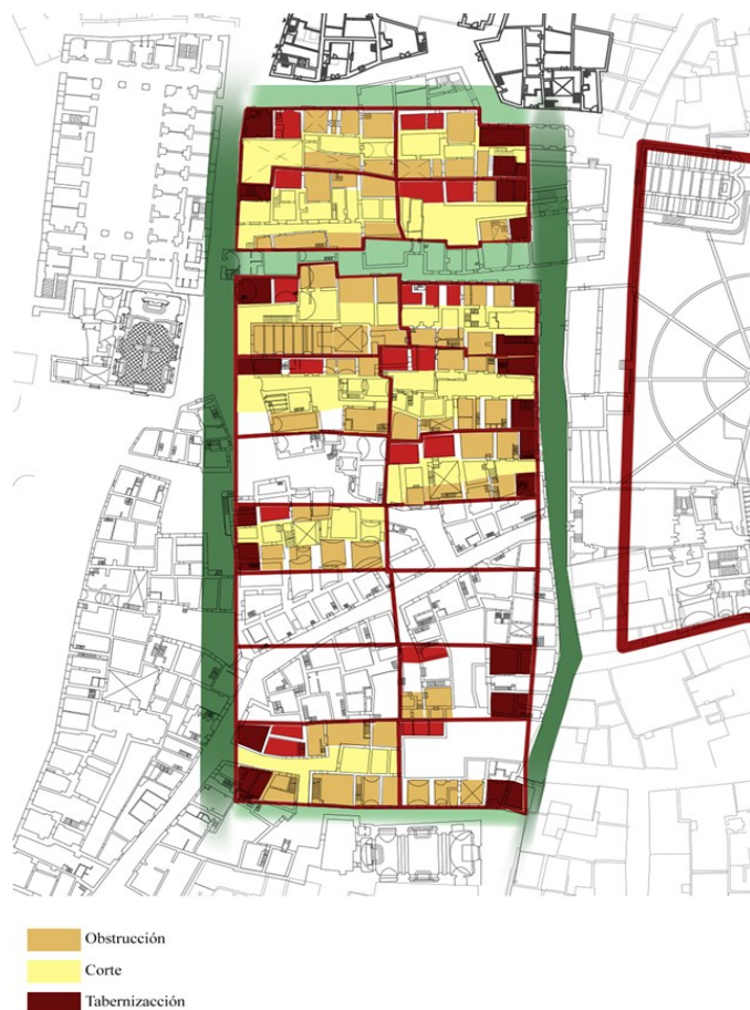
Fig. 25 Fase II, obstrucción de la corte y el proceso de tabernización
