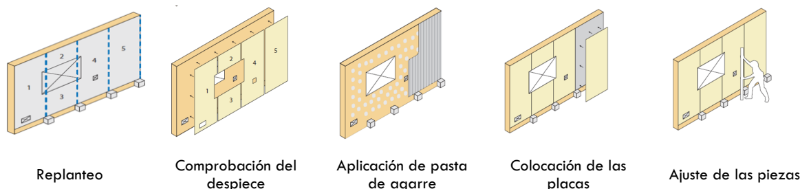
Fig. 8. Proceso de ejecución del revestimiento de placa de yeso laminado.
