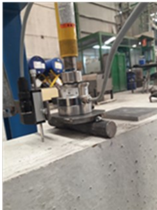
Fig. 12. Transductor de desplazamiento, célula de carga y cilindro de carga.
