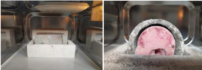
Fig. 4-5. Imágenes del conjunto Mufla/pieza en el interior de la cavidad del microondas con muestra C.M.7 para el quemado. (Fotografía de autor).
