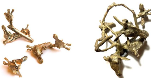
Figuras 10 y 11: Piezas fundidas en latón provenientes de molde refractario descerado y cocido en microondas con la mufla D. Título "Caducifolios") 30x23x32 mm
