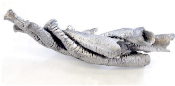
Figura 12: Trompas de elefante, fundida en aluminio a través de molde procesado con microondas
