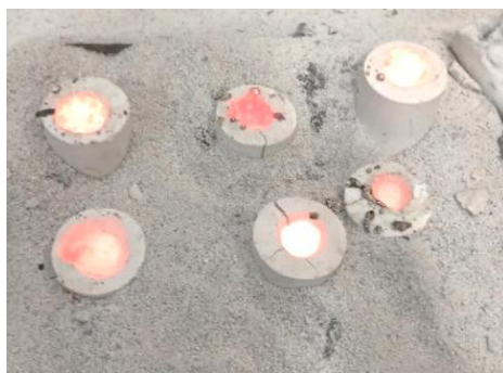
Figuras 1 y 2: Vista de molde cilíndrico para fundición introduciéndose en mufla MW, y vista en planta de 6 moldes enterrados en arena para efectuar la colada del metal fundido con seguridad.
