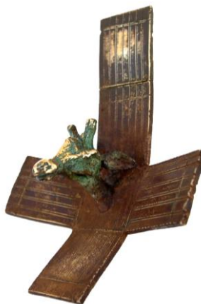
Figura 14: Broche de jirafa en una caja, fundida en latón proveniente de molde refractario procesado en microondas, 190x130x130mm
