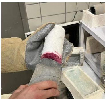
Figuras 1 y 2: Vista de molde cilíndrico para fundición introduciéndose en mufla MW, y vista en planta de 6 moldes enterrados en arena para efectuar la colada del metal fundido con seguridad.
