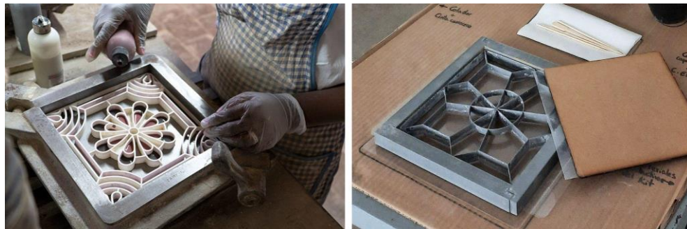
Figura 1. A la izquierda, sistema utilizado en Aldeas Infantiles SOS con molde tradicional de acero y trepa impresa en 3D. A la derecha, experimentación realizada en el Fab Lab ULL con sistema por capas adaptado del Proyecto Anda y trepa impresa en 3D
