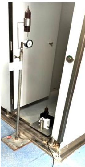
Fig. 4. Dispositivo (ES1293890 U) conectado a una viga sometida a un proceso de carga y descarga, junto con un reloj comparador para medir la deformación. (Fuente: elaboración propia)
