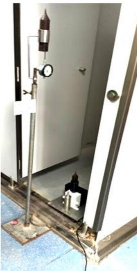
Fig. 4. Dispositivo (ES1293890 U) conectado a una viga sometida a un proceso de carga y descarga, junto con un reloj comparador para medir la deformación. (Fuente: elaboración propia)
