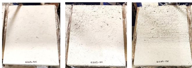
Fig. 1. Diseño de placas prefabricadas, ubicadas de izquierda a derecha por porcentajes del 5% a 15% de sustitución por NFU.
