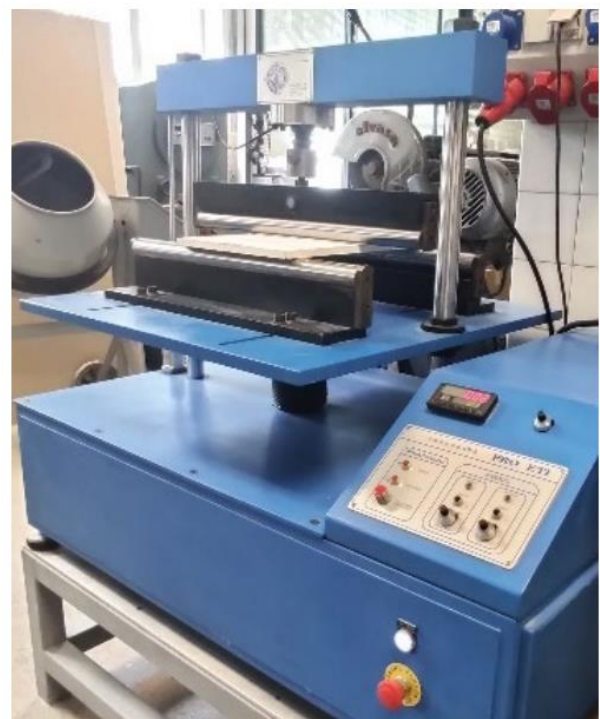
Fig. 3. Disposición para el ensayo a flexión en placas.
